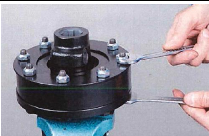
Fig. 9-7: Montering af friktionskoblingen
