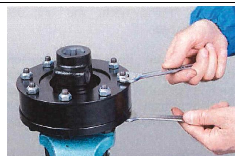
Fig. 9-2: Demontering af friktionskoblingen
