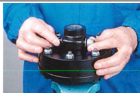
Fig. 9-1: Demontering af friktionskoblingen
