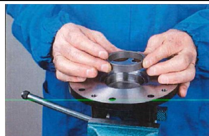
Fig. 9-5: Montering af friktionskoblingen
