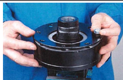
Fig. 9-6: Montering af friktionskoblingen
