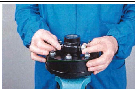
Fig. 9-3: Demontering af friktionskoblingen
