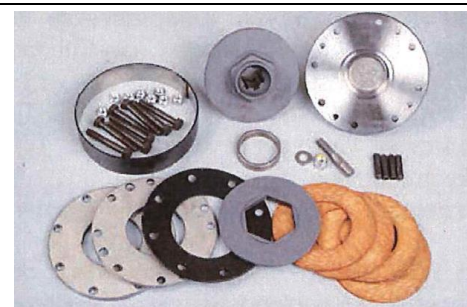
Fig. 9-4: Demontering af friktionskoblingen
