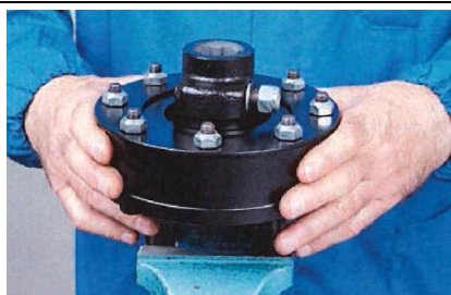
Fig. 9-8: Montering af friktionskoblingen
